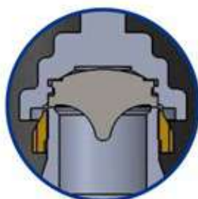
Conjunto de Vedação com Defletor para direcionamento de fluxo
